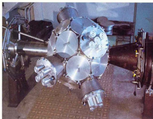
41 - СПЕКТРОМЕТР МНОЖЕСТВЕННЫХ СОБЫТИЙ (ФОСО) ДЛЯ ИССЛЕДОВАНИЯ СВОЙСТВ ЯДЕР НА ПУЧКАХ ТЯЖЕЛЫХ ИОНОВ
