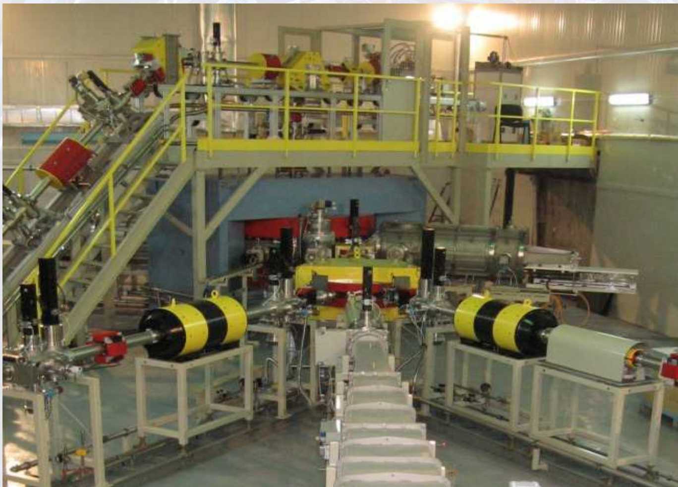
Рис. 4.2. Циклотрон ДЦ-60. Вверху – линия инъекции, ЭЦР источник. Внизу – линииразводки пучков и канал трековых мембран. Вверху слева – канал низких энергий.
